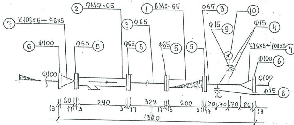
№2 со счетчиком ВМХ-50, фильтром ФМФ-50. Ввод  $\phi$  100 мм
